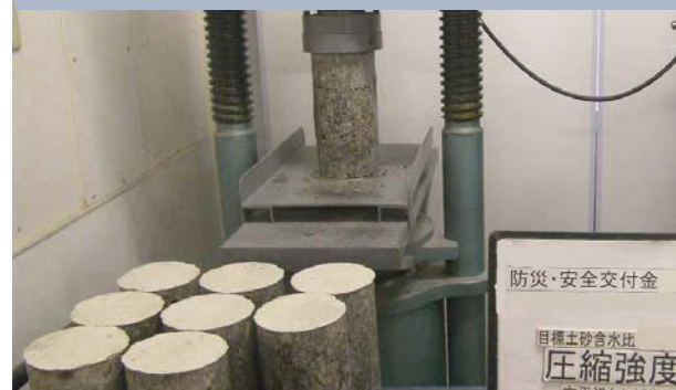
ソイルセメント配合試験
