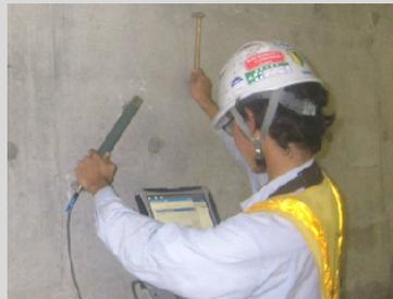
非破壊試験による強度測定(表面2点法)
