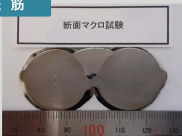
フレア溶接 断面マクロ試験
