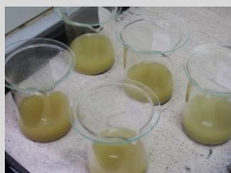
硝酸による試料分解状況
