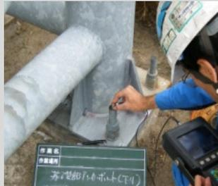
超音波によるボルト検査
