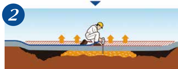
ウレテック樹脂をコントロールしながら注入し、膨張させます。
