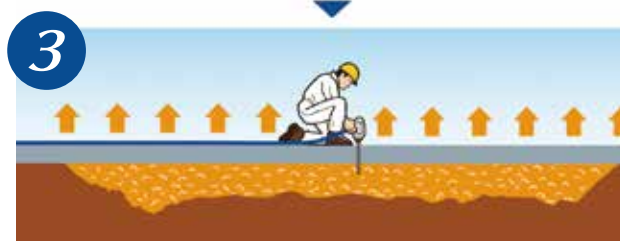
膨張力が地盤を締め固めさらに床を押し上げてミリ単位の精度で計測し床を水平にします。
