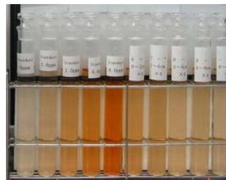
硬化コンクリート中の塩化物イオン量を調べ、鉄筋腐食性の評価を行います。
