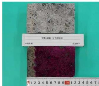
強アルカリ性の材料であるコンクリートにフェノールフタレイン溶液を噴霧し、構造物表面からの中性化深さを求めます。
