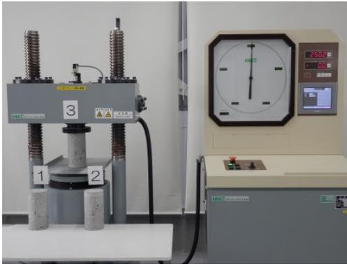
構造物より採取したコンクリートコアを圧縮破壊させ、圧縮強度を求めます。自動載荷型の圧縮試験機により載荷速度を制御し、試験精度の向上を図っています。
