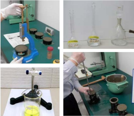
レディーミクストコンクリートの練混ぜに用いる水の試験として以下の5項目を試験します。
