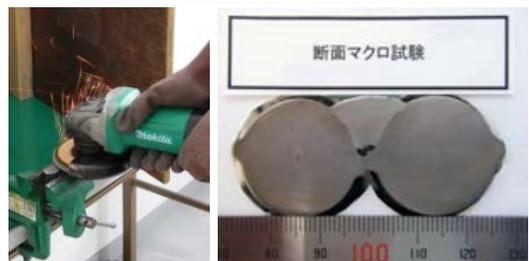
鉄筋溶接試験片を切断し、切断面を研磨して硝酸エタノールで腐食させた後、鋼の組織を目視観察します。主に鉄筋フレア溶接部の検査に用います。
