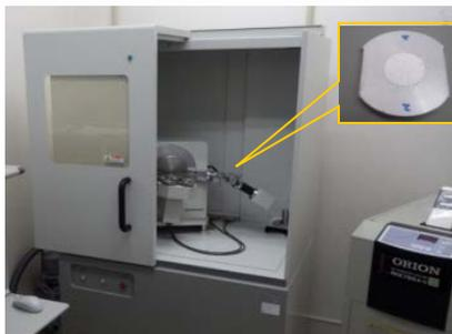
試料中に含まれる結晶性物質のX線回折ピークを測定し、岩石のASR判定や生成物の確認をします。
