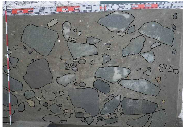
図 2 供試体切断による粗石充填状況 (CASE1)
