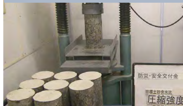
ソイルセメント配合試験
