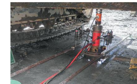
平板載荷試験は、地盤の支持力を評価する原位置試験です。載荷板に荷重を加え、沈下量を測定することで、地盤の剛性や安定性を把握します。基礎設計や施工管理に活用され、沈下リスクの低減に貢献します。
