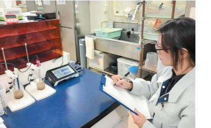
植物が健全に生育するためには、土壤の水素イオン濃度(pH)、養分、粒度組成など、さまざまな要因が関係しています。環境分析室ではpH、電気伝導率(EC)、窒素・リン・カリウムなどの養分、透水性、保水性、土壤硬度といった項目を測定し、植生工法や緑化工事に必要な基礎データを提供、土壤改良提案を行っています。
