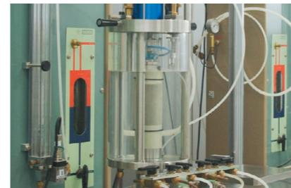
繰り返し非排水三軸試験は、地震による液状化リスクを評価する試験です。等方圧密した供試体に繰り返し荷重を加え、液状化強度を算出します。軟弱地盤の耐震設計や災害リスク評価に活用され、安全性と信頼性の向上に貢献します。
