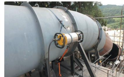
放射線透過試験は、X線やγ線で試験体内部を撮影し、傷を視覚的に検出する非破壊試験法です。X線装置は安全管理が容易で、γ線源は小型で狭所対応可能。品質保証や安全性確認に役立ちます。
