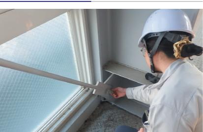
耐震診断や耐力度調査において、構造部材ではRC造の柱・梁・耐力壁のひび割れや鋼材腐食の確認、S造では部材接合部の確認を行います。また、非構造部材では各設備設置状況や劣化状況の確認を行います。不同沈下量の測定結果をもとに耐震性能を把握し、構造計算結果も含め総合的に評価した上で、補修強度設計を含む改修計画を立案します。
