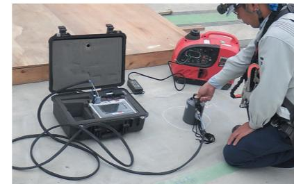
表層透気試験は、コンクリート表面の密実性を非破壊で評価する検査法です。透気係数に基づき性能を5段階で分類し、新設構造物の品質確認や改質材・含浸材の効果検証に活用できます。耐久性確保や維持管理の精度向上に有効です。
