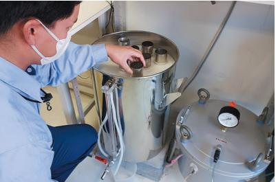
各種試験により土が水を蓄える能力(保水性)を評価します。砂柱法、加圧板法、遠心法と幅広いpF値の測定をカバーしており、水分特性曲線の作成や有効水分保持量算出にも対応しております。試験結果は地盤改良の工法検討や、植栽用客土・造園資材の品質管理に有効です。
