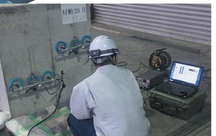
表面吸水試験(SWAT)は、コンクリート表面の吸水性を非破壊で評価する試験です。吸水カップで水位変化を測定し、吸水速度を算出。品質確認や改質材の効果検証に活用され、維持管理に有効です。
