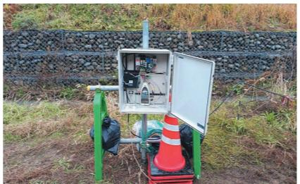
騒音振動常時遠隔監視装置は、建設工事や交通の騒音・振動をリアルタイムで監視。データはクラウド送信で効率化し、基準超過時は警報を通知。工事や交通による影響を監視します。
