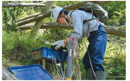
パイプひずみ計は、地すべり地に埋設して地盤の変形を検出する計測器です。高感度ですべり面位置やひずみ量を計測することができる。ひずみ量の定期観測の結果により、地すべりの変動ランクが決まり、対策工の設計に活用されます。
