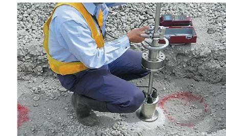
FWD (Falling Weight Deflectometer)は、載荷板上に重錐を自由落下させることにより衝撃荷重を加え、これにより生じた変位量から地盤反力係数を求める装置です。路床・路盤の土構造物の剛性評価として使用されています。
