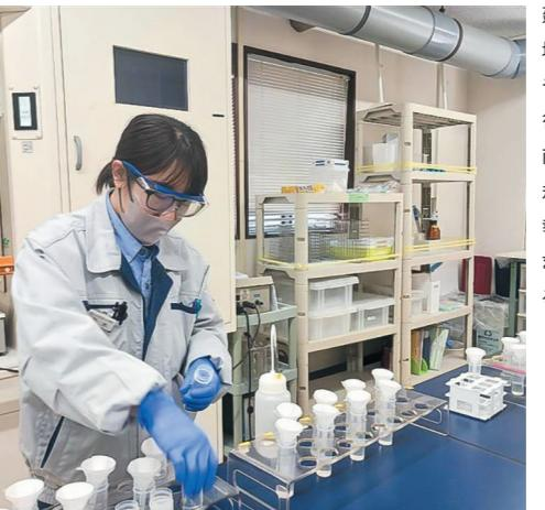
建設工事において発生する残土の搬出・搬入に伴い、土壤分析を行い、汚染拡散の防止に貢献します。環境基準や、土壤汚染対策法に準じた分析を行い基準値評価を行います。県の土砂条例や盛土条例、東京港埠頭や阪南二区などの埋め立て地、UCR受け入れ地など、様々な規格に対応した分析を行い、多岐にわたる様式に沿った報告書の作成を行っております。
