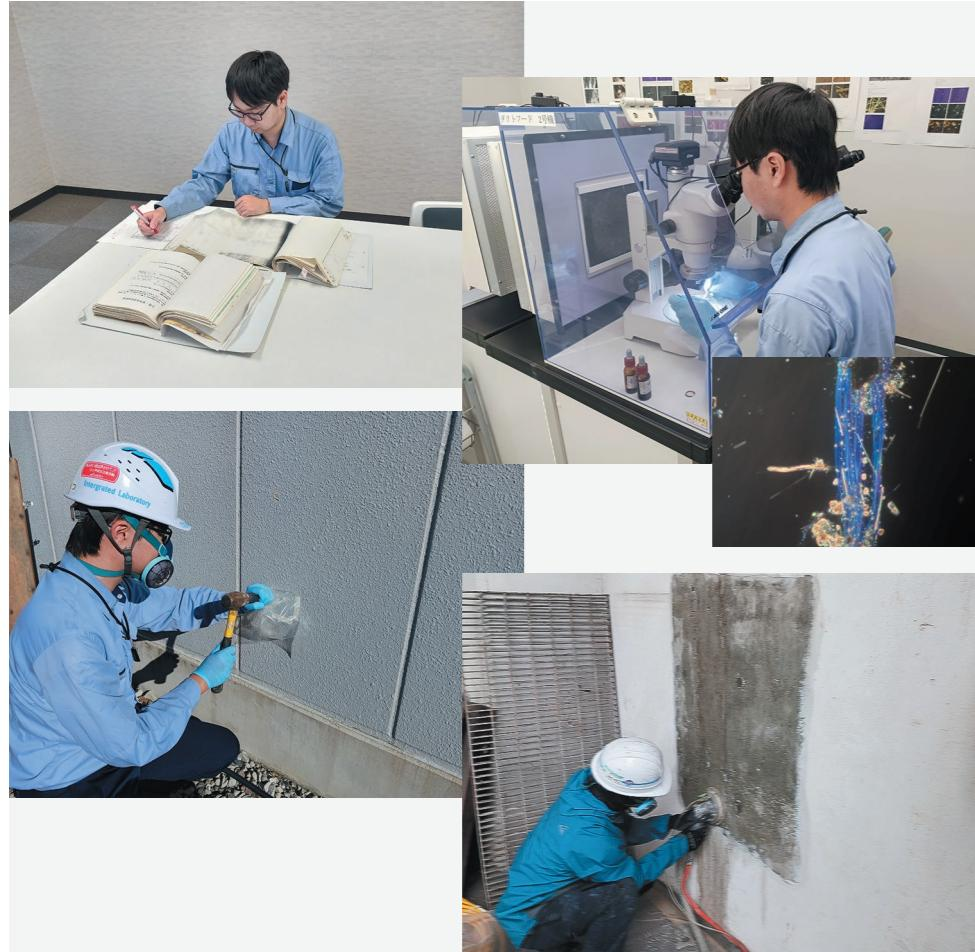
アスベスト調査は、解体・改修工事に伴う石綿粉じん曝露を防ぎ、労働者および周辺住民の健康被害を未然に防ぐために重要です。令和5年の法改正により、有資格者による事前調査が義務化され、規模に応じて調査結果の電子申請も必須となったことで適切な事前調査の重要性は一層高まっています。当社では、書面調査、現地での目視確認、試料採取・分析、さらに必要となる除去工事まで、一連の工程をワンストップで対応しております。
