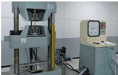
引張試験は、鋼材に荷重を加え破断までの応力やひずみを測定し、強度や降伏点、伸びなどを評価する試験です。設計性能の確認や品質保証に不可欠な検査手法です。
