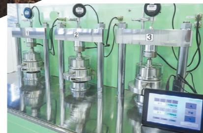
圧密試験は、地盤の沈下量や沈下時間を評価するための係数を求める試験で、段階的に荷重を加え時間経過に伴う沈下を測定します。軟弱地盤対策や構造物の沈下予測に活用され、設計の信頼性と施工の安全性向上に寄与します。
