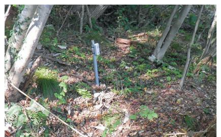
地表変位観測は、地すべりや土砂崩壊の予兆・進行状況を把握可能なため、施工現場の安全管理や周辺地域への安全予防の手段として用いられます。計測器に内蔵される加速度センサーにより、地表変位を計測。さらに遠隔監視システムと連動させることにより、大規模崩落等の予兆を周知することができます。
