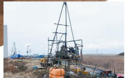
地質調査のために地面に孔を掘り、地層や地盤の性質、地下水の状況を把握する手法です。ボーリング孔を利用して様々な試験・計測を行い、構造物の設計・施工に必要な地盤情報を得るため、地質調査として一般的且つ必要不可欠な手法となります。
