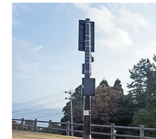
自動観測監視システムは、現場の計測装置と遠隔地の事務所を回線で接続し、伸縮・傾斜・水位・雨量・画像などのデータをリアルタイムで取得・監視します。太陽電池による自家発電と無線LAN、省電力無線、携帯回線、衛星通信など柔軟な通信手段により、電源やケーブル敷設が不要で、迅速な導入が可能。施工現場や災害監視における効率的な情報収集と安全管理に貢献します。
