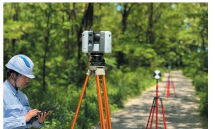
固定式測量は、地盤の変動を高精度で監視し、災害リスクの評価や復旧計画に活用されます。GPSやレーザースキャナを用いた継続的な観測により、異常の早期検知と迅速な対応が可能です。
