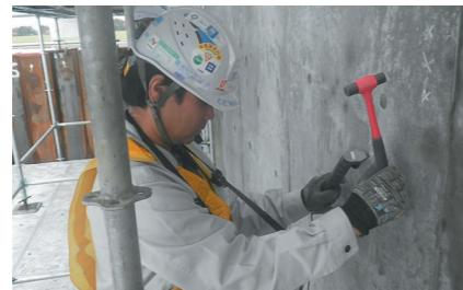
衝撃弾性波試験は、弾性波速度を測定し、コンクリートの圧縮強度を非破壊で推定する試験です。橋台や橋脚などで迅速に実施でき、構造物の健全性確認や補修計画に活用されます。
