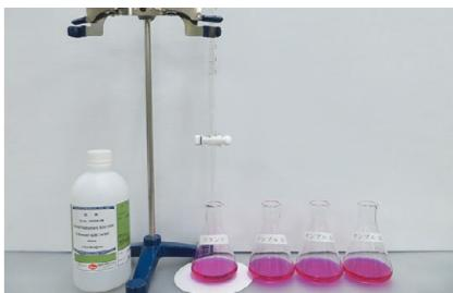
アルカリシリカ反応性試験は、骨材とアルカリ成分の反応による劣化を評価する試験です。ゲルの膨張によりコンクリートにひび割れが生じ、耐久性が低下します。事前評価により、材料選定や補修リスクの低減に役立ちます。
