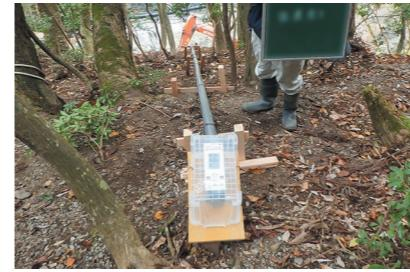
地表伸縮計は、地すべりや地盤変動の監視に用いられます。インバーア線の伸縮量を測定し、亀裂の拡大や移動状況を把握。変状の進行を早期に検知し、対策工の設計や施工管理に活用されます。
