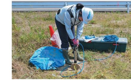
孔内傾斜計は、「挿入式」と「設置式」の2種類があり、すべり面の位置や変動量を計測することが目的です。ボーリング孔に埋設したガイド管に測定器(プローフ)を挿入し、ガイド管の変位(曲がり)の初期値と計測値の差から変位量を求めることが特徴です。
