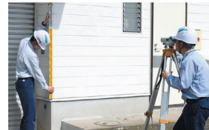
現地調査は、家屋の外観や内部の状態を写真や測定で記録し、傾斜や亀裂の有無を確認する調査です。工事前後の変化を分析し、報告書を作成することで、施工管理や住民対応に活用され、トラブル防止に貢献します。
