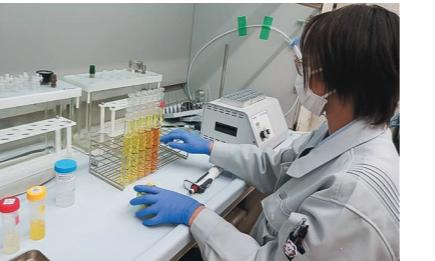
当社では河川水、排水、練り混ぜ水、井戸水、農業用水、ダム湖の水質調査など様々な水質分析を行っております。また、工事現場では施工前、施工中、施工後の3段階で河川水の分析を実施することで、工事による河川への影響を把握、対策の提案を行っています。
