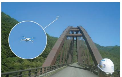
UAVによる橋梁点検は、高解像度撮影で損傷を確認し、近接目視が困難な箇所も点検可能。画像を図面と結合し管理でき、過年度比較も容易。足場が不要でコスト削減かつ、安全性も向上します。
