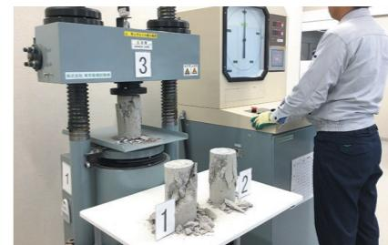
圧縮・曲げ強度試験は、所定材齢の供試体を加圧し、コンクリートの耐久性と安全性を確認する品質管理の要です。ゼネコンや建設コンサルタントは、設計性能の保証や施工リスク低減に活用できます。
